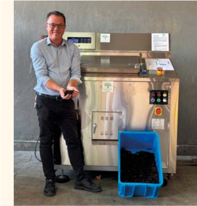
Déshydrateurs de bio-déchets mis en place sur les Carrefour Contact en Guadeloupe. David Budnyk, responsable HSE & Technique au sein de Carrefour Guadeloupe.
